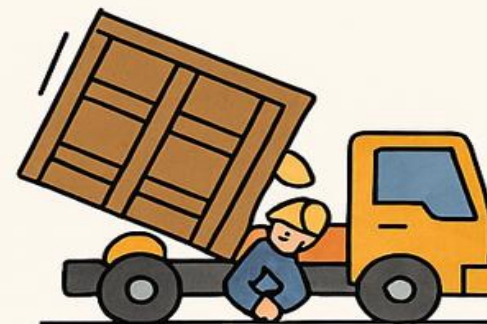
překlopení konstrukce umístěné na ložné ploše nákladního vozidla vedoucí k přimáčknutí zaměstnance
